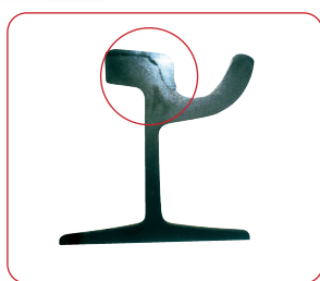
Schnitt durch die Ober- u. Flankenaufschweißung des Schienenkopfes
