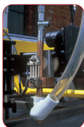
Detail navařovací hlavy
