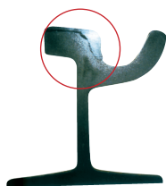
Řez horním a bočním návarem kolejnice
